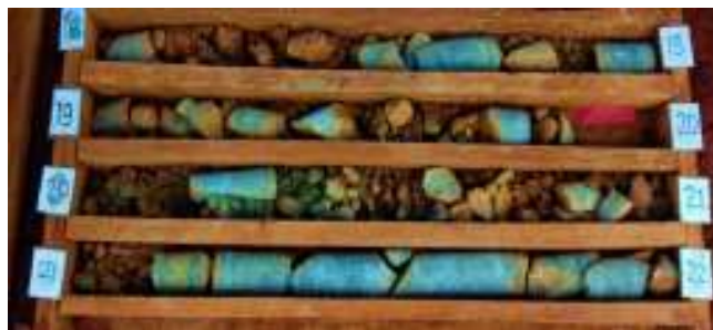
Gambar 5 Kenampakan bedrock dari satuan Hazburgit dari titik bor ULR-14
