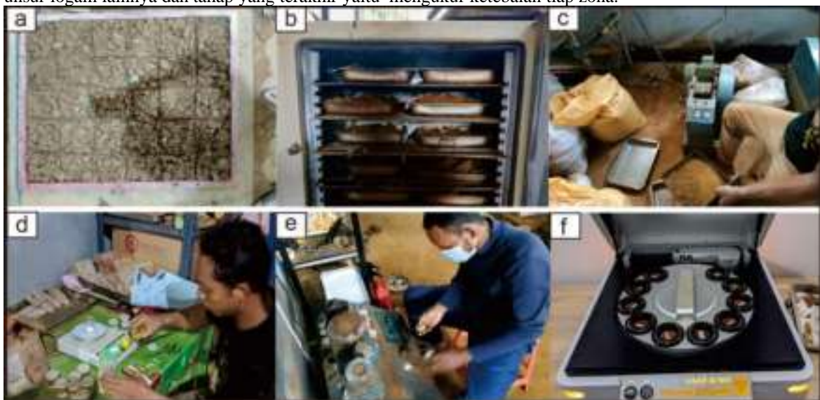
Gambar 3. Tahap mixing (a), tahap pengeringan (b), tahap crushing dan menghaluskan (c) tahap menimbang sampel pulp (d), tahap pressing untuk membentuk keping (e) dan tahap analisis laboratorium (f).
