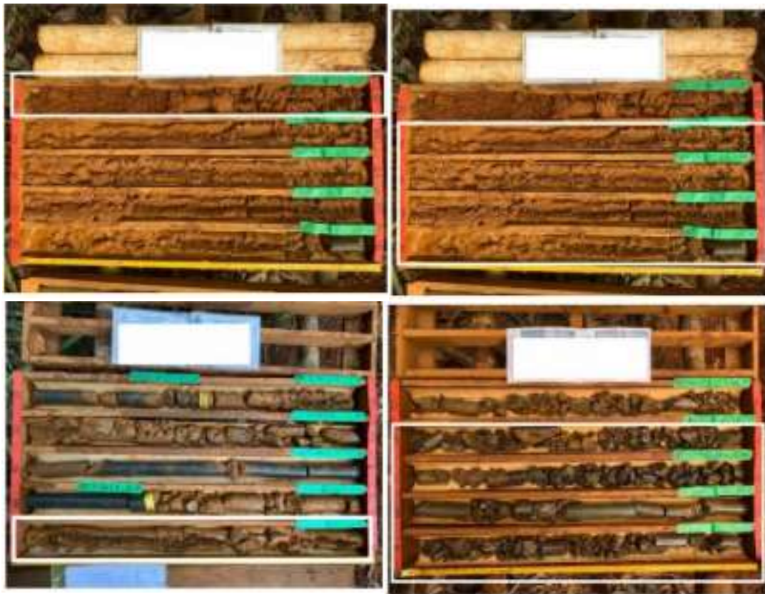
Gambar 3. Kenampakan zona topsoil, zona limonite pada corebox, zona saprolite dan zona bedrock.
