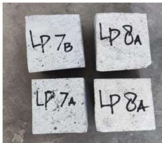
Gambar 2 Sampel yang telah dipotong kubus
