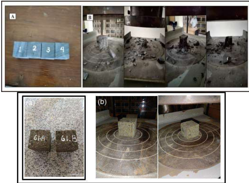
Gambar 2. (A) Sebelum melakukan uji kuat tekan. (B) Setelah melakukan uji kuat tekan.
