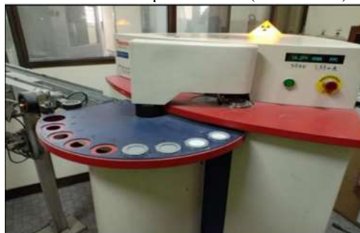
Gambar 3. Alat yang digunakan untuk mengetahui unsur-unsur pada sampel ( X-Ray Fluorescence ).
