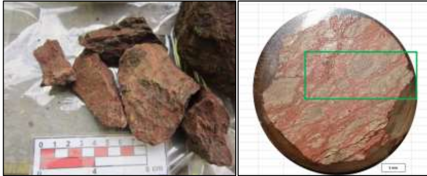
Gambar 2. Sampel yang dilakukan uji analisis mikro-XRF dengan kode KS-001, (a) sampel untuk analisis XRF bulk, (b) sayatan polosh untuk analisis mikro-XRF dengan batas scan kotak hijau.
