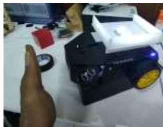
Gambar 7. Pengujian sensor ultrasonik
