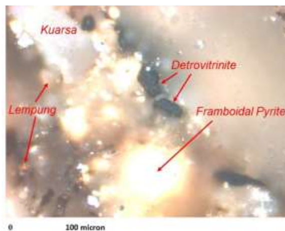
Gambar 11. Kenampakan mikroskopis framboidal pirit (piritik sulfur), kuarsa dan lempung serpih karbonan Formasi Ngrayong
