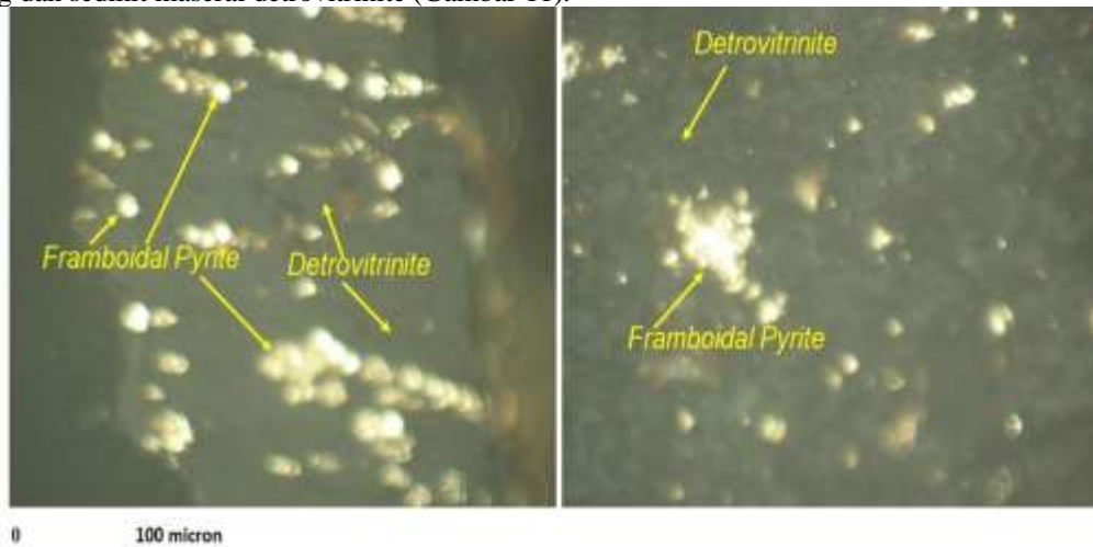
Gambar 10. Kenampakan mikroskopis framboidal pirit (piritik sulfur) batubara Formasi Ngrayong
