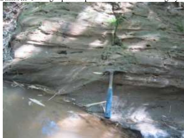
Gambar 7. Singkapan batupasir kuarsa struktur cross bedding dan bioturbasi Formasi Ngrayong
