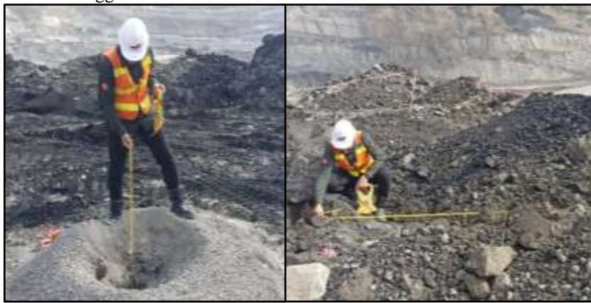
Gambar 1. Pengukuran tinggi stemming dan crest burden
