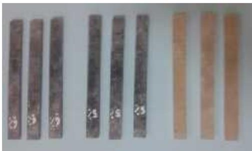
Gambar 3. Sampel untuk pengujian bending
