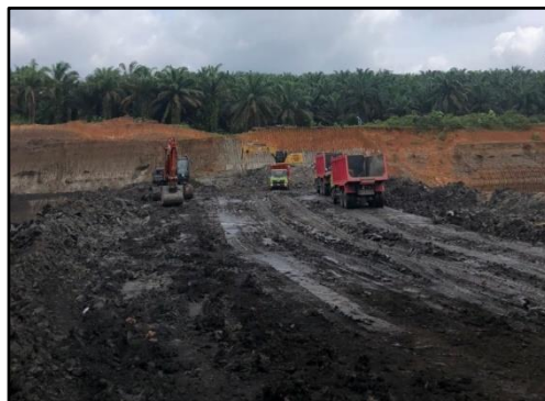
Gambar 2. Pola Pemuatan Top Loading dan Single Back Up
