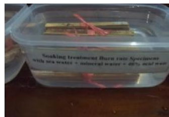
Gambar 1. Proses perlakuan rendaman spesimen komposit.
