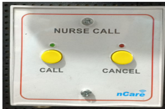
Gambar 3. Tampilan fisik perangkat pemanggil
