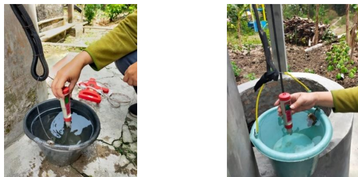
Gambar 7. Proses deskripsi fisik dan pengukuran DHL, suhu, TDS dan pH dilapangan pada air tanah sumur dangkal lokasi Sum-1 (kiri) dan lokasi Sum-4 (kanan)
