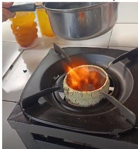
**Gambar 2.** Kompor dengan bahan bakar minyak jelantah yang sudah diolah menjadi biodiesel
