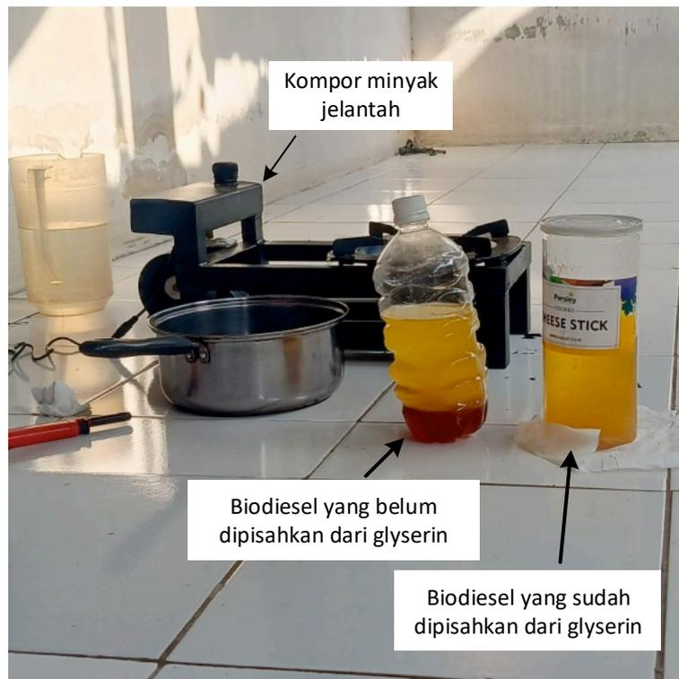
**Gambar 1.** Kompor dengan bahan bakar minyak jelantah yang sudah diolah menjadi biodiesel
