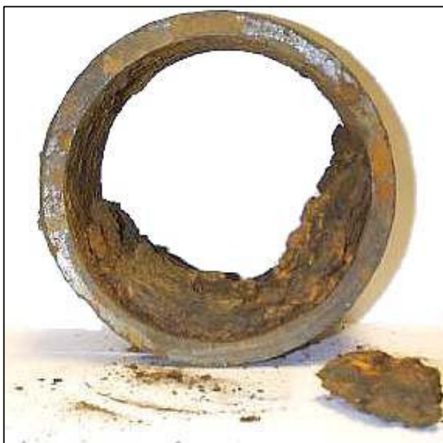
Gambar 1. Scale pada pipa produksi
