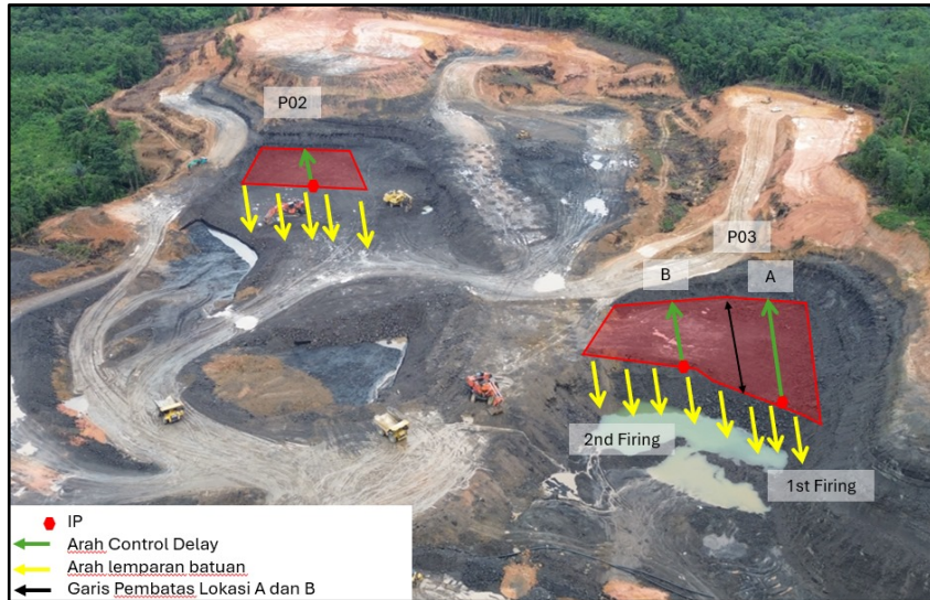
Gambar 3. Arah Lemparan Batuan Berdasarkan Initiation Point
