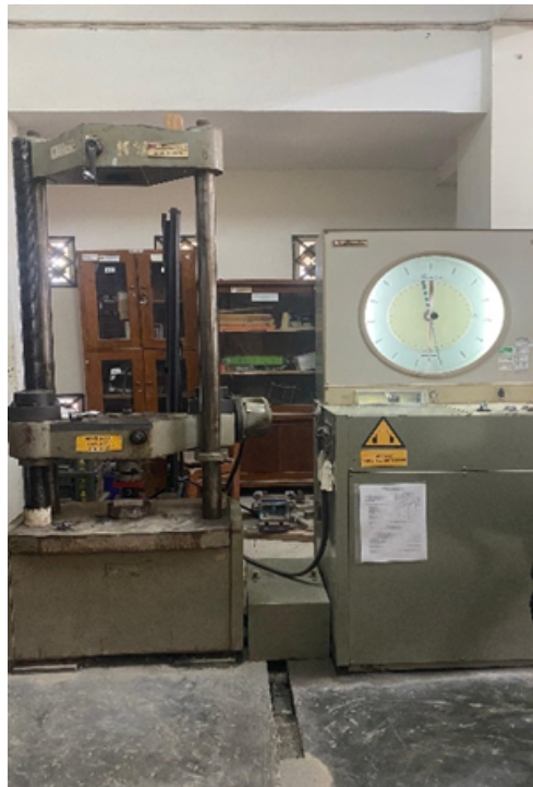
Gambar 4. Uji Kuat Tekan Mortar Geopolimer
