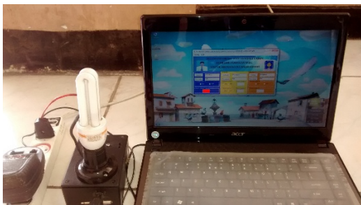
Gambar 18 Pengujian Lampu Dalam Keadaan Rusak
