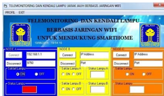
Gambar 19 Indikator Saat Lampu Rusak
