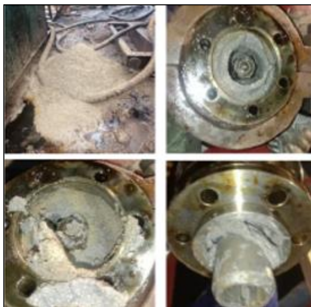
Gambar 3. Temuan pasir di dalam string ESP
