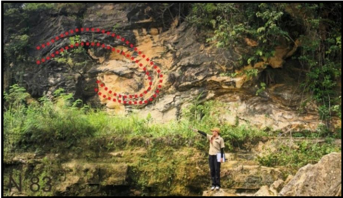
Gambar 7. Struktur Slump (Dengan arah dominan Timur Laut – Barat Daya) yang di Dapati di Lapangan (Arah singkapan N 83° dengan Panjang singkapan \pm 4 Meter dan lebar singkapan \pm 8,3 Meter).
