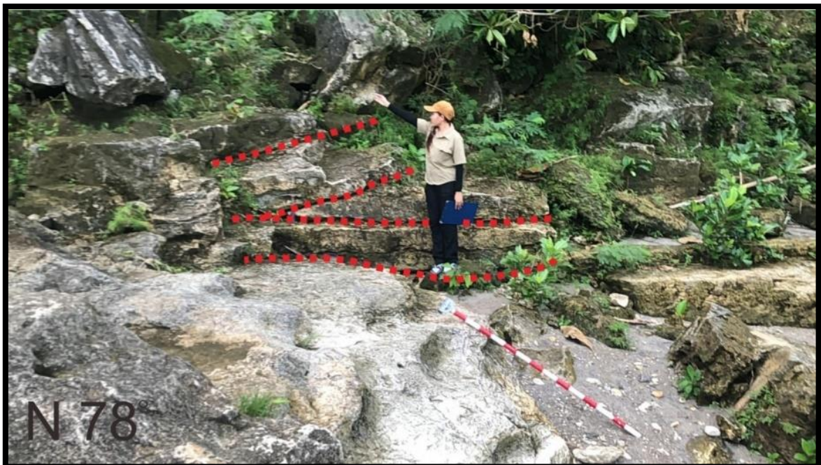
Gambar 8. Struktur Cross-Bedding yang di Dapati di Lapangan (Arah singkapan N 83° dengan Panjang singkapan \pm 7,2 Meter dan lebar singkapan \pm 1,4 Meter).
