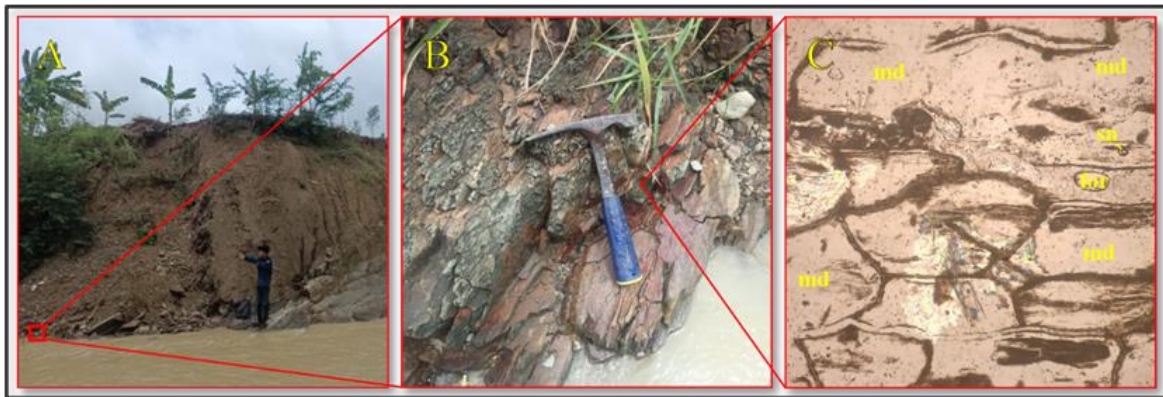
Gambar 6. Satuan Napal/Mudstone. Kenampakan singkapan pada Lokasi Penelitian (A), Kenampakan Napal/Mudstone dengan struktur massif secara megaskopis (B), Kenampakan Kenampakan Napal/Mudstone secara mikroskopis (C), fosil foraminifera (for), sand (sn), mud (md)
