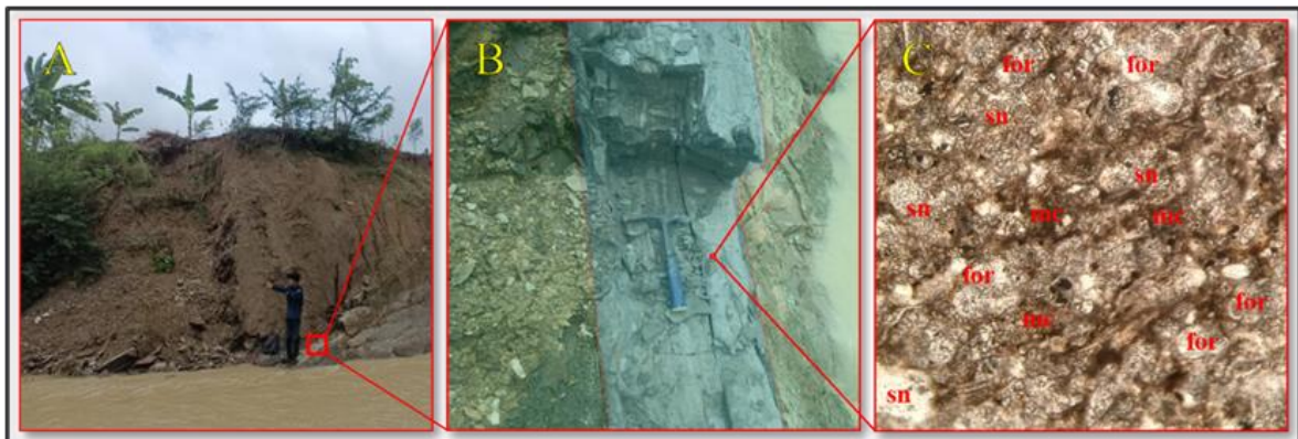
Gambar 4. Satuan Batuan kalkarenit/Grainstone. Kenampakan singkapan pada Lokasi Penelitian (A), Kenampakan batuan kalkarenit/Grainstone secara megaskopis dengan kedudukan batuan N 305°E/85° (B), Kenampakan batuan kalkarenit/Grainstone secara mikroskopis (C), fosil foraminifera (for), sand (sn), micrite (mc)
