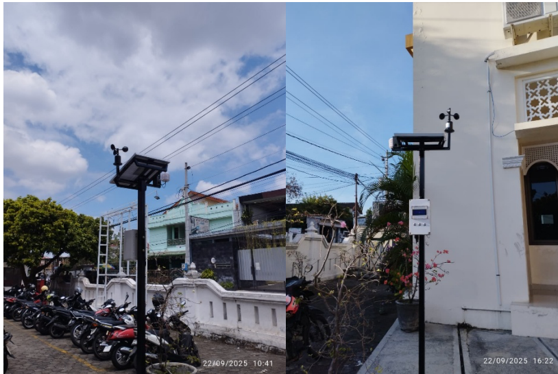
Gambar 2. Uji lapangan alat pemantauan cuaca self-sustain berbasis IoT saat proses pengambilan data di area terbuka Kampus ITNY.
