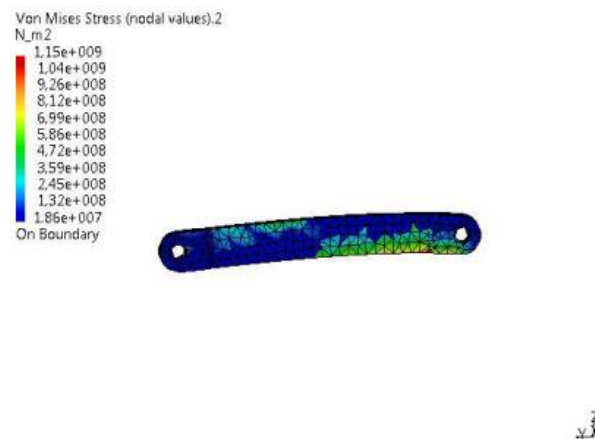
Gambar 3. Hasil analisis tegangan pada long linkage
