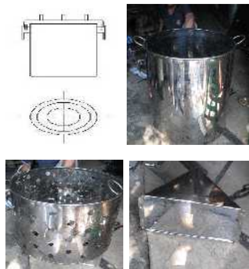
Gambar 1. Desain dan pembuatan ketel sederhana
