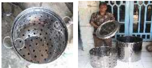
Gambar 2. Komponen ketel pengukusan
