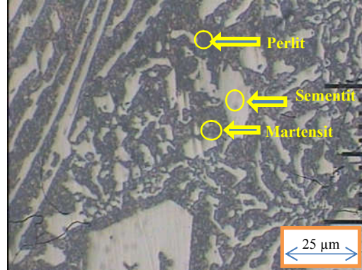
Gambar 3. Struktur mikro besi tuang putih ASTM A532 setelah temper 250°C
