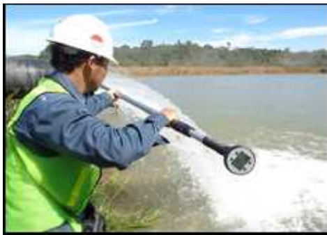
Gambar 3.2 Pengukuran Debit air pompa menggunakan Globalwatermeter
