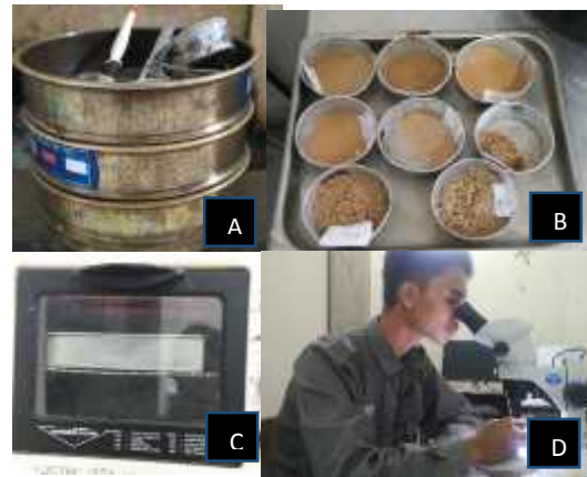
Gambar 3. Peralatan dan proses pengamatan mikrofosil. A. Peralatan (Mesh/saringan, cawan, kuas), B. Hasil saringan berupa residu, C. Oven, D. Proses pengamatan.
