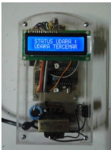
Gambar III.4 Alat pengukur tingkat polusi udara berbasis mikrokontroler menggunakan sensor TGS2600
