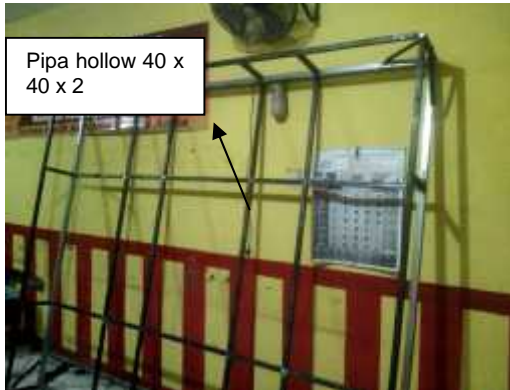
Gambar 15. Rangka hollow yang telah dirangkai menjadi satu bentuk untuk corong cyclone
