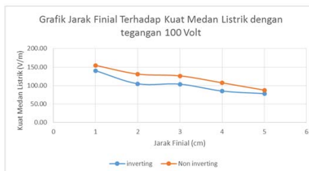
Gambar 11 Grafik Kuat Medan Listrik Rata-rata terhadap Jarak Finial dengan Tegangan Konstan 100 Volt
