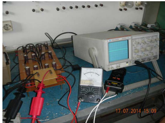
Gambar 10 Rangkaian pengukuran tegangan keluaran dari tegangan searah
