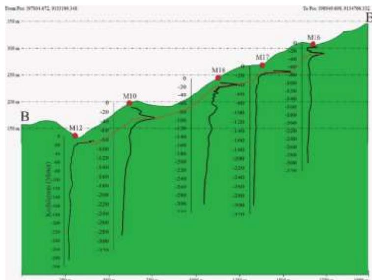
Gambar 8. Model lapisan pada pengukuran di lintasan BB'
