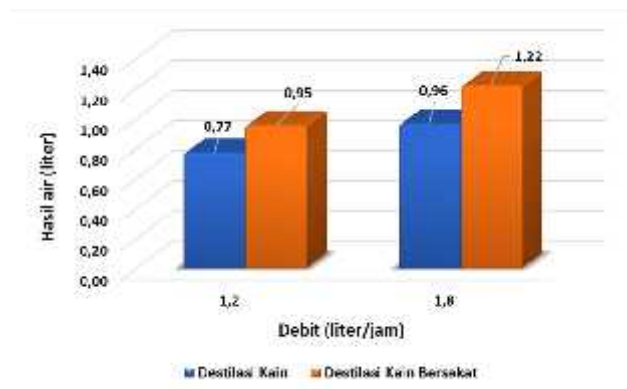
Gambar 8. Perbandingan hasil air destilasi antara destilasi kain dan destilasi kain bersekat pada setiap variasi debit menggunakan kolektor
