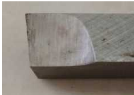
Gambar 2. Hasil keausan tepi pahat yang paling terkecil
