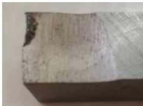
Gambar 3. Hasil keausan tepi pahat yang paling terbesar
