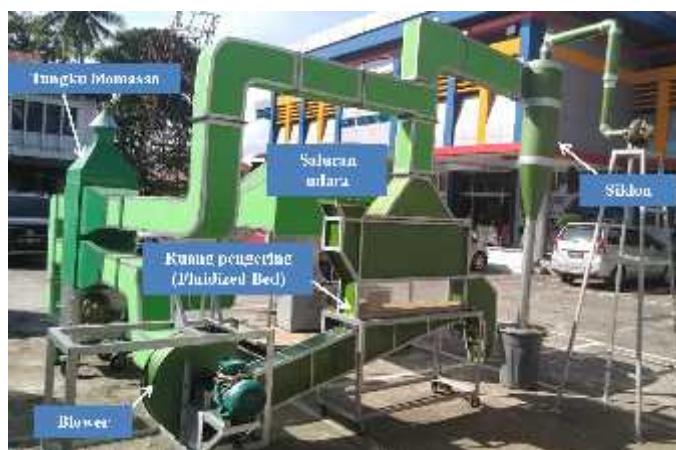
Gambar 1. Photo alat pengering fluidisasi terintegrasi dengan tungku biomassa dua tingkat
