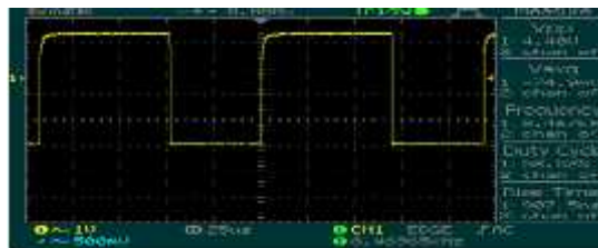
Gambar 4. Pengujian Rangkaian Clock 8 kHz
