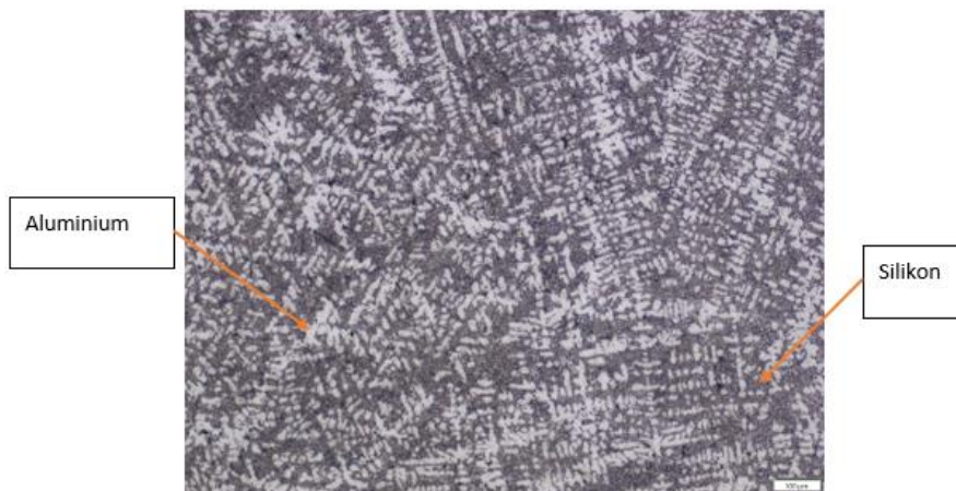
Gambar 3. Struktur Mikro Velg Mobil x dengan Perbesaran 100X
