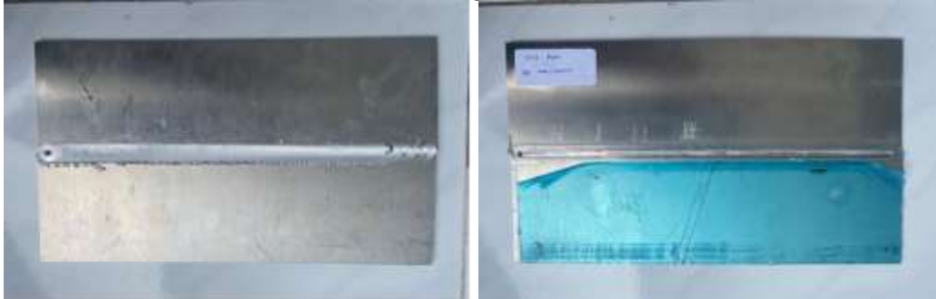
Gambar 3. Hasil Pengelasan FSW dengan Putaran 1500 rpm dan feed rate 180 mm/menit tampak atas dan bawah.
