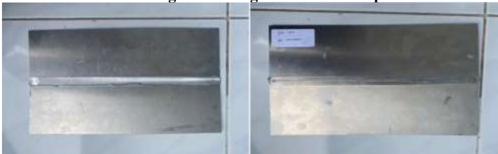
Gambar 2. Hasil Pengelasan FSW dengan Putaran 910 rpm dan feed rate 180 mm/menit tampak atas dan bawah.
