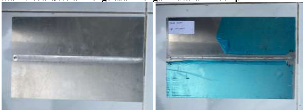
Gambar 4. Hasil Pengelasan FSW dengan Putaran 2200 rpm dan feed rate 180 mm/menit tampak atas dan bawah.
