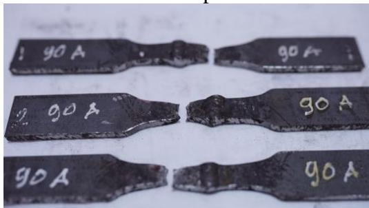
Gambar 9. foto micro spesimen HI 942,28 J/mm
