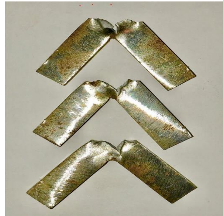
Gambar 11. Heat input 122,12 Joule/mm
