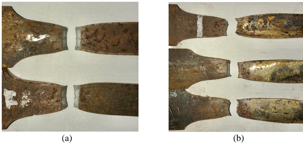
Gambar 7.(a) Raw Material : (b) WM dengan Heat input 122,12 Joule/mm
