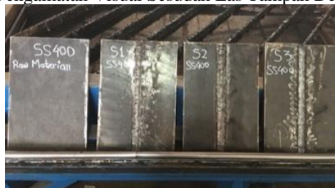
Gambar 4. Pengamatan Visual Sesudah Las Tampak Belakang ( Tembusan )
