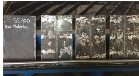
Gambar 3. Pengamatan Visual Sesudah Las Tampak Depan ( Capping )
