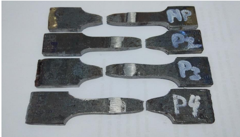
Gambar 9. Spesimen uji tarik setelah dilakukan pengujian tarik
