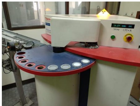
Gambar 3. Alat yang digunakan untuk mengetahui unsur-unsur pada sampel ( X-Ray Fluorescence ).
