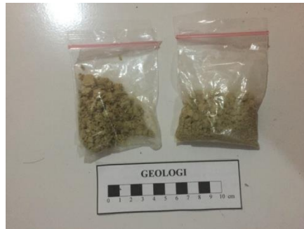
Gambar 2. Dua sampel dari Satuan batuan batugamping terumbu Klitik yang sudah dihaluskan dan dikeringkan.
