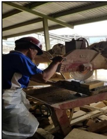
**Gambar 9.** Proses pemotongan batu menjadi bentuk kubus Sumber Area industri PT. SEMEN PADANG
