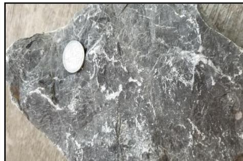
**Gambar 4** Bentuk batu basal yang akan dilakukan proses uji kuat tekan Sumber Area tambang PT. SEMEN PADANG
