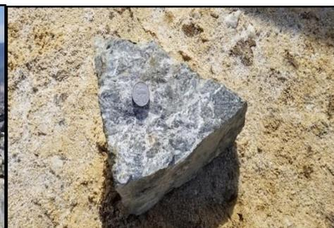
**Gambar 6** Bentuk batu Pasir silika yang akan di lakukan proses uji kuat tekan Sumber Area tambang PT. SEMEN PADANG
