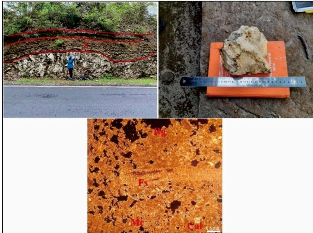
Gambar 6. Kenampakan lapangan dan sayatan XPL Floatstone II dengan arah foto N 105 0 E pada LP 101
