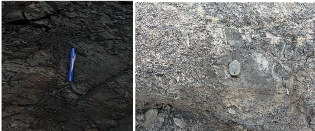
Gambar 4. Kenampakan contoh batubara (Kiri) dan lapisan batu lempung (Kanan) pada seam selatan
