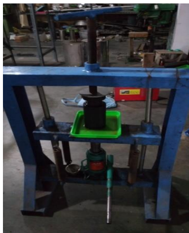
Gambar 3. Pengepresan kulit jeruk menggunakan alat pres hidrolis
