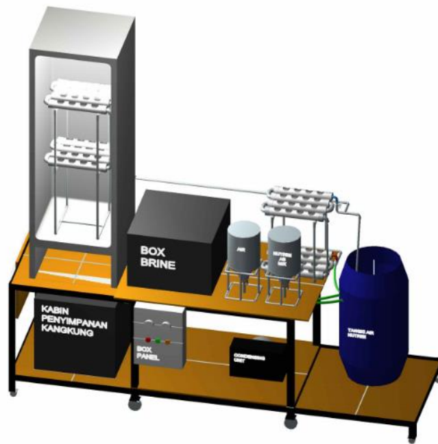
Gambar 3. Konstruksi sistem mesin brine cooling
